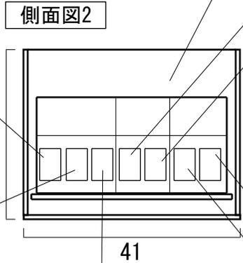
DC電源入力端子-      DC電源入力端子+      DC出力端子+      DC出力端子- (GND)
