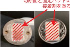
②エンドキャップに固定パッドを取り付け、固定パッドとネオンフレックス切断面に接着剤を塗ります。固定パッドとネオンフレックスの間に隙間ができるよう、切断面とパッドの全面にしっかりと接着剤を付けてください。
