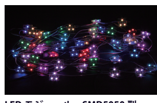
LED モジュール、SMD5050 型、3 球 1 アドレス x50 モジュール、RGB (フルカラー)、LOR 互換
