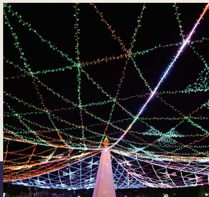
LED モジュール、SMD5050 型、 3 球 1 アドレス x50 モジュール、 RGB(フルカラー)、LOR 互換
