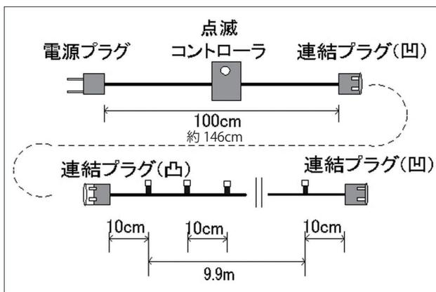
付属の点滅コントローラー: 8パターンを押しボタンで選択可能 ※メモリ機能搭載
